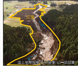
3.崩壊土砂が土石流化して下流まで流出
